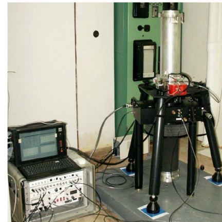
Obr. 1 Absolutní gravimetr FG5 č. 215 a jeho schéma
